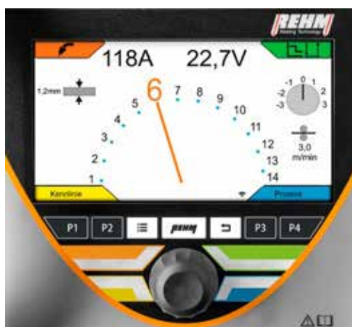
Abbildung: Bedienung 2, angelehnt an stufengeschaltete Geräte
