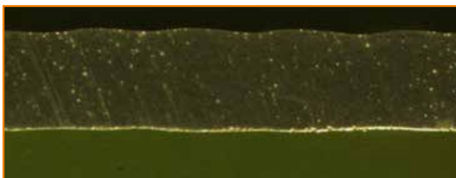
Reparaturschweißung konventionell mit AC geschweißt. Mit der üblichen Porenbildung.
