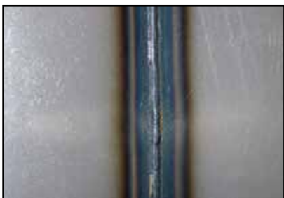
■ Staal stompe las PG | 2,0 mm FOCUS.ROOT
