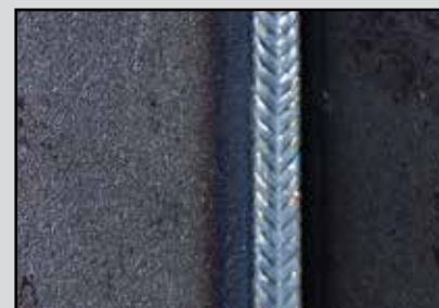
■ Staal hoeklas PF | 5,0 mm POWER.PULS (als dubbelpuls)
