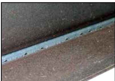
■ Staal hoeklas PB | 8,0 mm FOCUS.ARC
