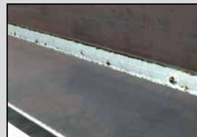
■ Staal hoeklas PB | 10,0 mm FOCUS.ARC
