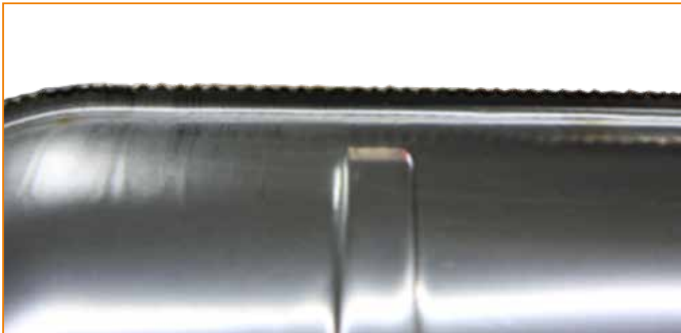
Edelstahl Tank mit 250 Heftpunkten
