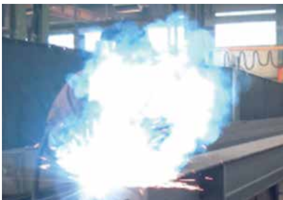
Vroeger: Aanzienlijke rookontwikkeling met conventionele vlamboog.
