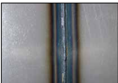
■ Staal stompe las PG | 2,0 mm FOCUS.ROOT
