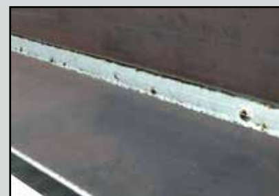
■ Staal hoeklas PB | 10,0 mm FOCUS.ARC
