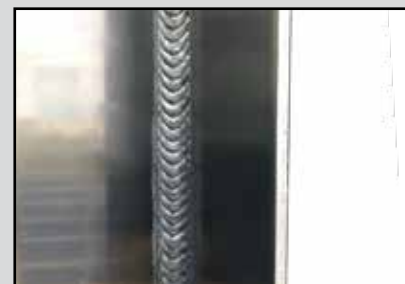
■ Aluminium hoeklas PF | 3,0 mm POWER.PULS (als dubbelpuls)
