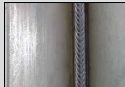
■ CrNi hoeklas PF | 5,0 mm POWER.PULS (als dubbelpuls)
