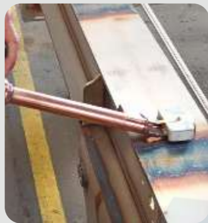
Herstellen van inox chassis : - Inductoren Large L20B4
