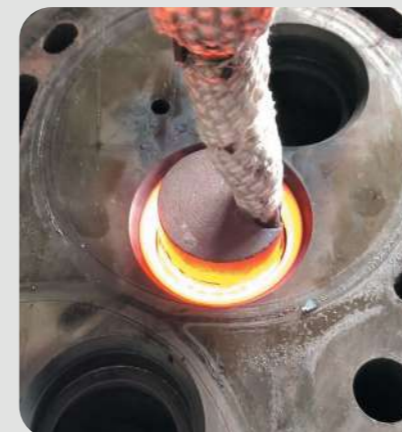
Opwarmen van ventielzittingen : - Inductor Heat Tube S180/D40 - Afmeting Ø 40
