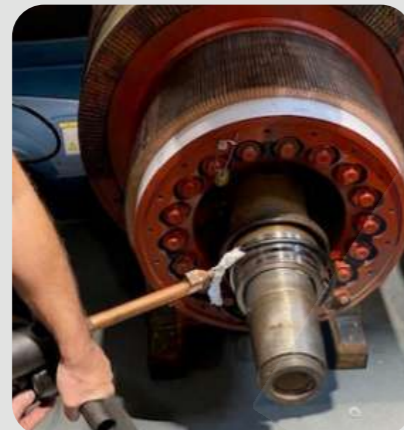
Verwijderen van metalen ringen van een elektrische motor : - lusvormige inductor L20/D200 - Powerduction 220LG
