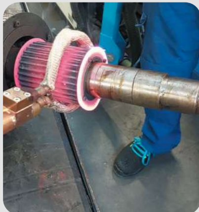
Opwarmen van een tandwiel : - lusvormige inductor L180 - Powerduction 220LG
