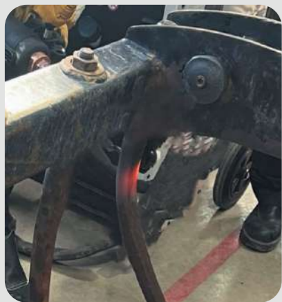
Herstellen van tanden van bakken van graafmachines : - Inductoren Large L20B4 - Powerduction 220LG
