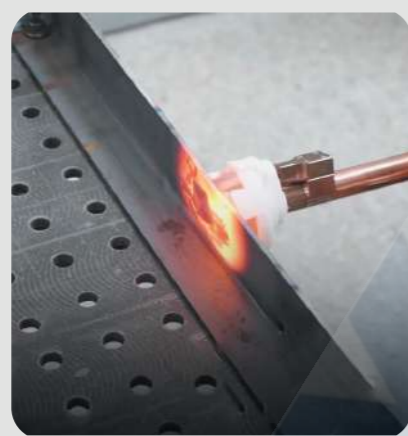
Het herstellen van gelaste onderdelen : - Inductor L180/Spiraal
