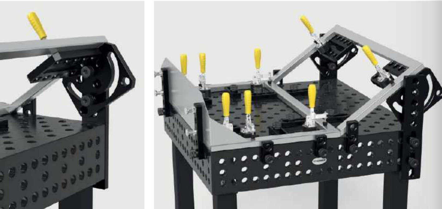
Basisplaat met sleufgaten genitreerd Combinatie van een vierkant met de glijdende basis maakt verschuiven in twee assen mogelijk, Materiaal: GGG40
